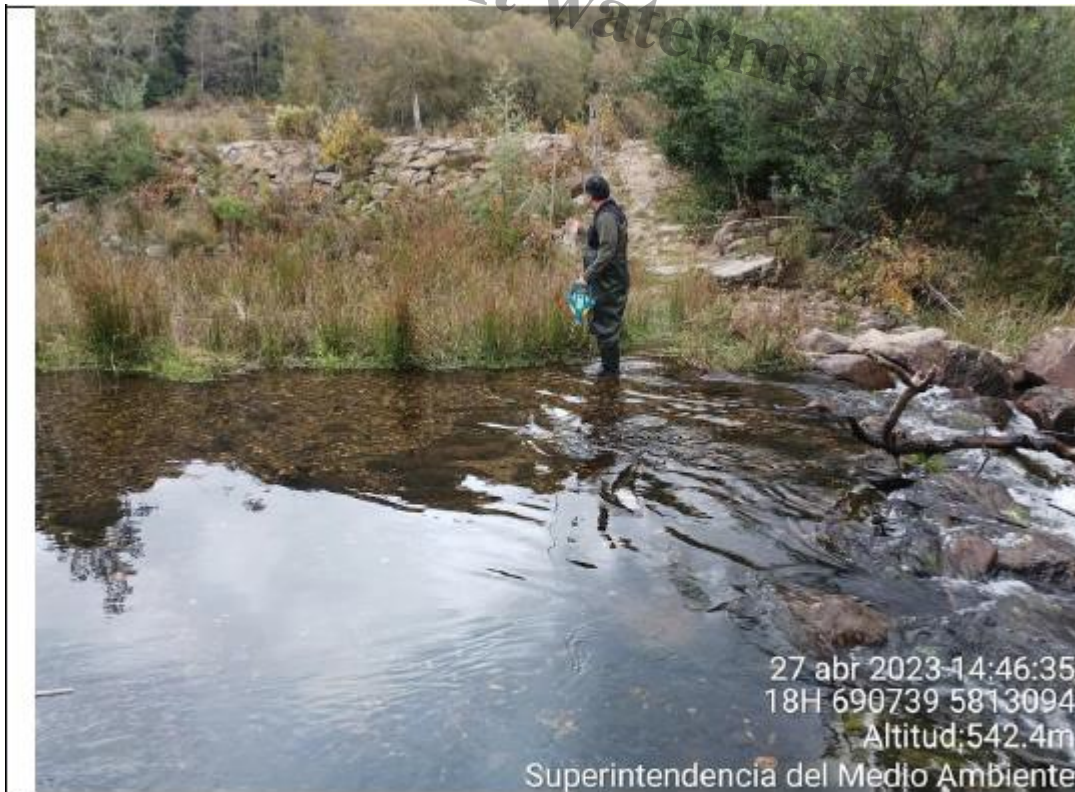
Fotografía 4. Fecha: 27/04/2023. Descripción del medio de prueba: Punto de muestreo de caudal ecológico en Río Picoiquén. En esta sección del río se efectúa la medición de caudal del río por persona de la DGA Región de La Araucanía.
